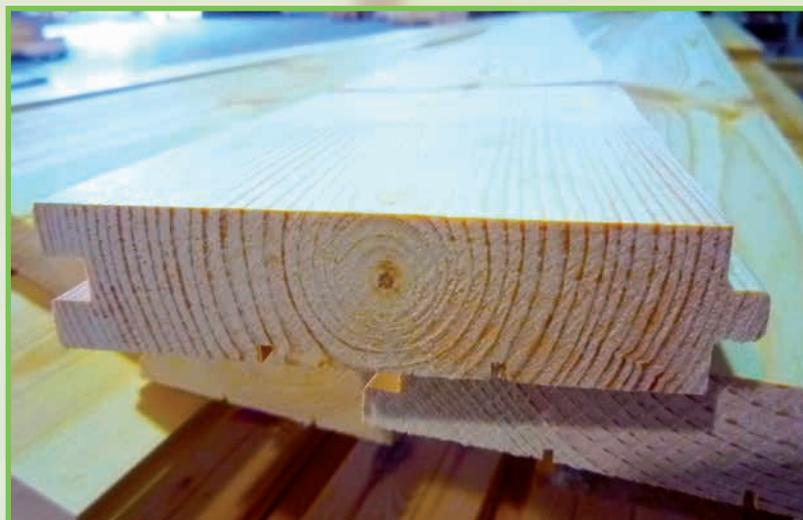
La planche de parquet séchée, rabotée avec plume et rainure, est en bois de pin spécialement sélectionné avec les dimensions suivantes:
