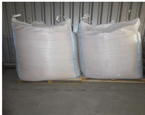
El Pellet puede ser empaquetado en sacos tipo big-bag de 1000 kg o 1200kg. Adicionalmente, con un coste añadido, existe la posibilidad de ponerlo en palés desechables, no normalizados, de medidas 1200mm x 1000mm. Las big bag se deben separar del suelo, poniéndolos encima de los palés. El Pellet se debería almacenar en espacios cerrados, ventilados y secos, no debería estar expuesto a la acción de las condiciones atmosféricas y rayos solares, que dañan el plastificado en el cual está envuelto.
