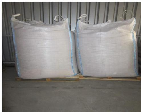
Granulés emballés dans des big-bags de 1000 ou 1200kg, placés sur une palette de 1200 mm x 1000 mm (en option payante). Il est impératif d'isoler les sacs du sol en les empilant sur des palettes. Les granulés doivent être stockés dans des pièces fermées et sèches. Ils ne doivent pas être exposés aux conditions météorologiques et à la lumière du soleil, car ceci a un effet négatif sur les sacs d'emballage.
