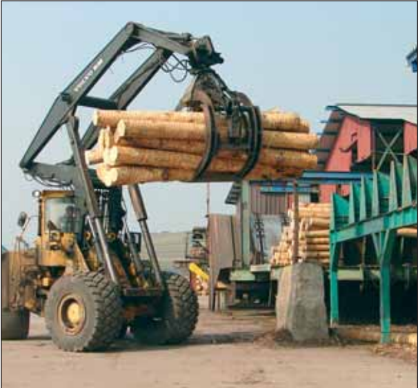
Załadunek kłód dowożonych na linię przetarcia
